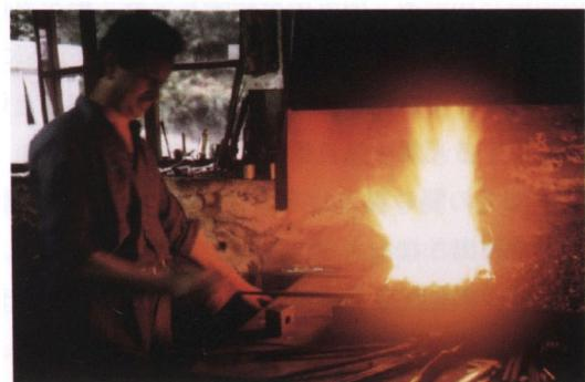
図12 轍での鍛冶工程（ミラーニ大理石道具工場）
