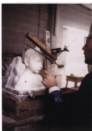
図15 原型の星取り機取り付け
