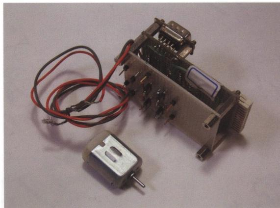
写真 11 DCモーターコントロールドライバPCB
