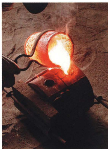
写真17 原型から作った型への鋳込み
