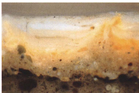
図81 図79の中央部分 紫外線蛍光写真 フィルターブロックA 写真縦寸法が0.19mmに相当
