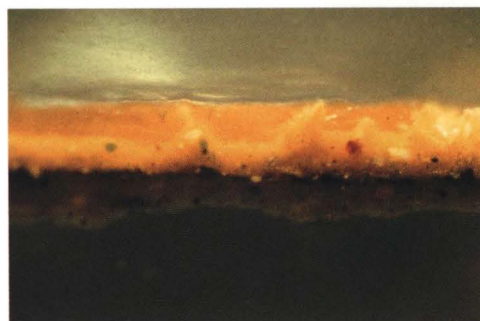
図79 図76からのクロスセクション 下層から 1. 地塗り(黄土) 2. 絵具層(褐色) 3. ワニス(黄色く半透明) 写真縦 寸法が0.76mmに相当
