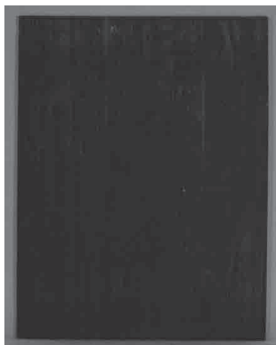
図10. 裏蓋外側の紫外線蛍光写真 内側に比べ、外側に塗られた塗料が暗く写っている。
