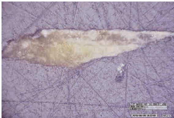
図8 地塗り試料・クロスセクション（×350）
