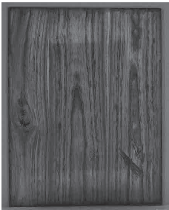
図9. 裏蓋内側の紫外線蛍光写真 内側には塗料は塗られておらず、木地のままである。
