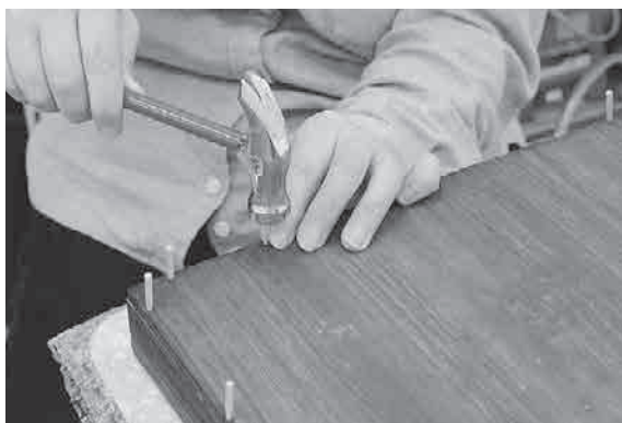
図37. 新規の木釘の打ち込み
