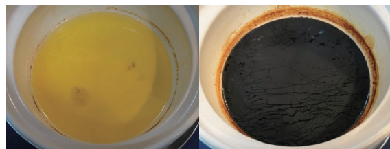
図21. 荏油 加熱前→加熱後
