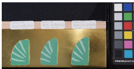
図36. 塗布直後（左から桐油、荏油、亜麻仁油）
