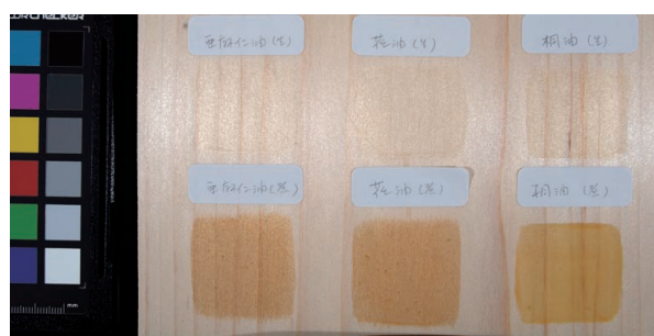
図24. 塗布直後（上段：生油、下段：密陀油） 左から亜麻仁油、荏油、桐油
