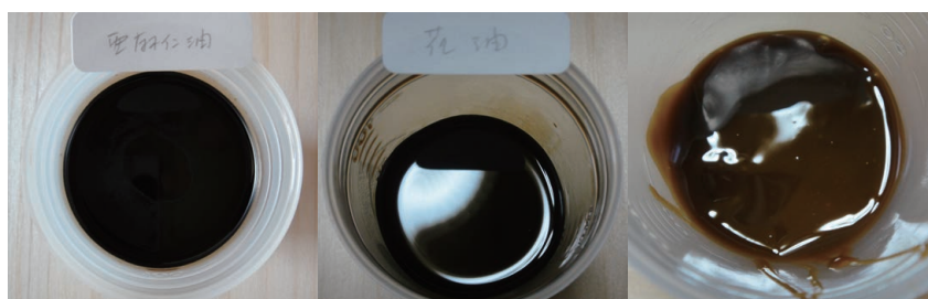
図23. 密陀油 左から亜麻仁油、荏油、桐油
