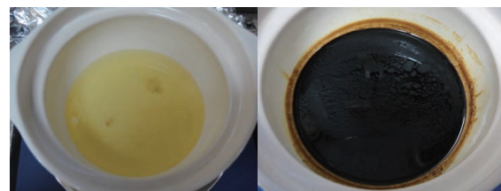
図20. 亜麻仁油 加熱前→加熱後
