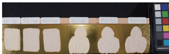
図28. 塗布直後(左は平塗り: 左から桐油、荏油、亜麻仁油、右は鶴の羽根部分: 左から桐油、荏油、亜麻仁油)
