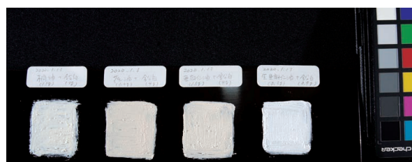
図27. 2週間後（右から生油、亜麻仁油、荏油、桐油）
