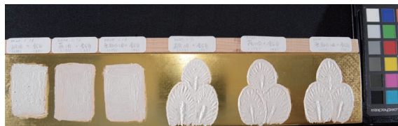
図29. 2週間後(左は平塗り: 左から桐油、荏油、亜麻仁油、右は鶴の羽根部分: 左から桐油、荏油、亜麻仁油)
