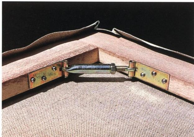
写真8 画面寸法拡大のための木枠四隅用金具。
