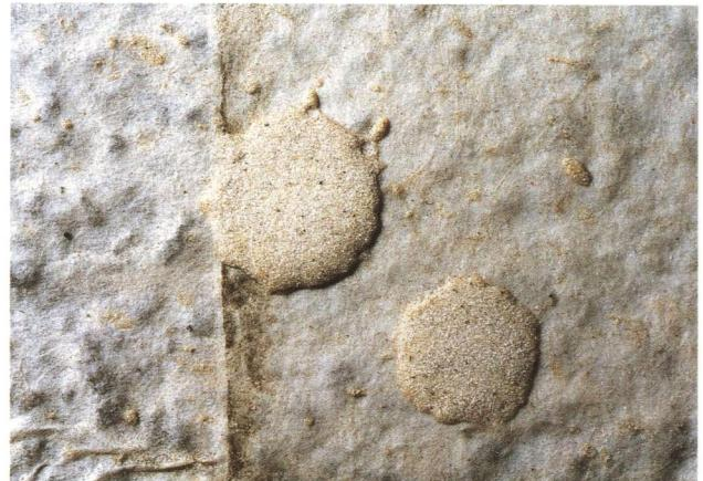
図34：図28の画面左上部分、研磨剤による厚塗り
