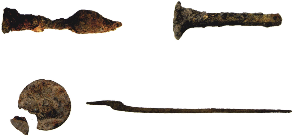
図2 各腐食レベルの鉄製遺物。上左：レベル1、上右：レベル2、下左：レベル3、下右：レベル4
