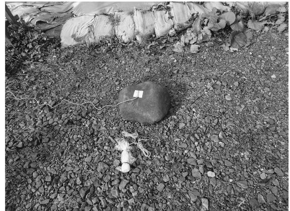
図2. 地表面、20cm深さの地温および石表面の温度測定
