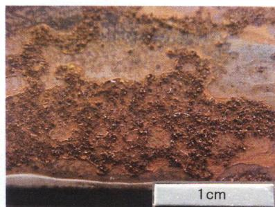
Fig.4 溶液に2時間浸せきした後、60日間25°C 85%RH霧囲気で曝露した鉄板表面。
