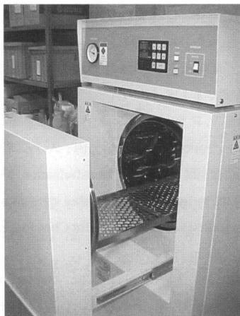
Fig.1 高温高压脱酸素水（AC）による脱塩装置
