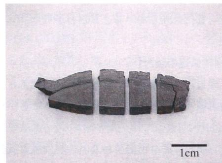
Fig.2 NaOH水溶液法とAC法の脱塩効果の比較・検討に用いた試料。開陽丸遺跡出土の砲弾破片（SM）、19世紀
