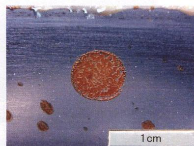
Fig.3(B) 液滴を滴下後、60日間25℃ 85%RH霧囲気で曝露した軟鋼（SS400）と鋳鉄（FC250）の表面。
