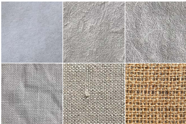
図14(左上から:三彩紙、楮紙(厚手)、楮紙(薄手)、大麻布、亜麻布、黄麻布)
