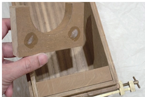
図102. エポキシ系接着剤による接着
