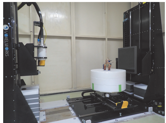
Fig.1 X線CT透過撮影の様子
