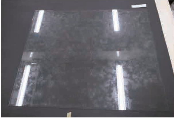
図9. ガラス板に生じたカビ（処置前）
