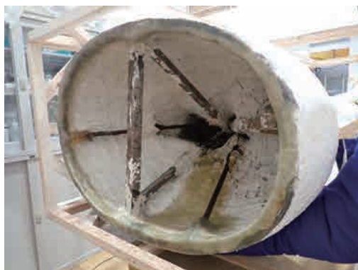
図10 ガラスクロスを貼って周辺部を補強した状態
