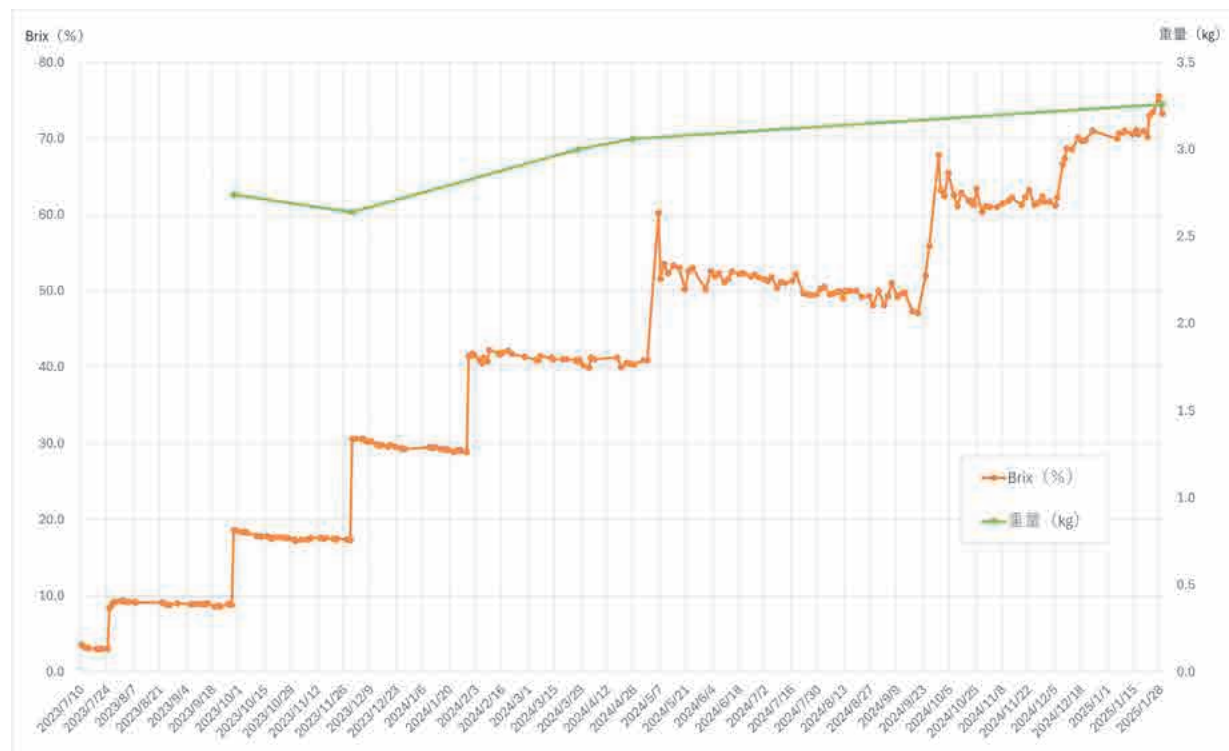
Fig.2 木柱小 含浸処理溶液の濃度変化
