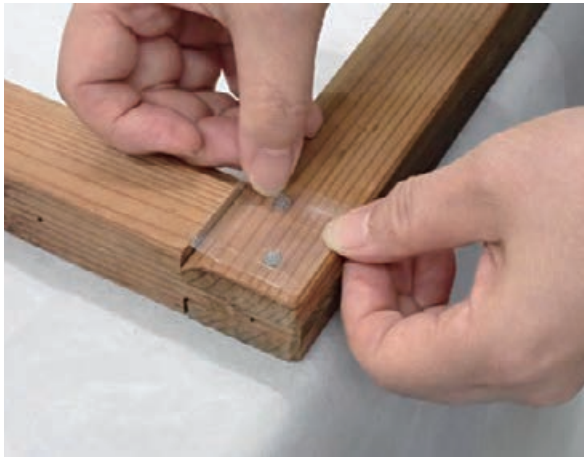
図1-21. 木枠の釘部分の養生
