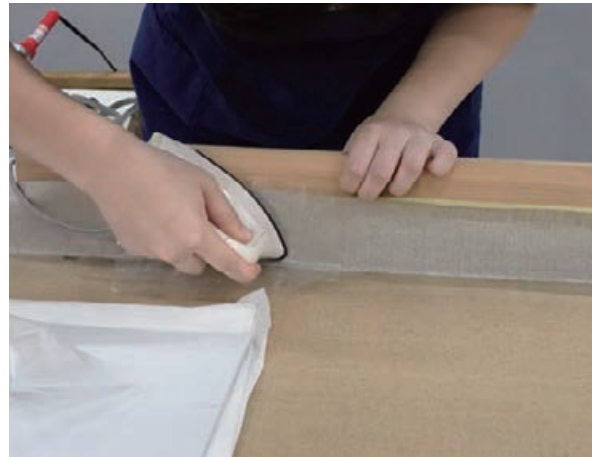
図1-22. 張りしろの補強
