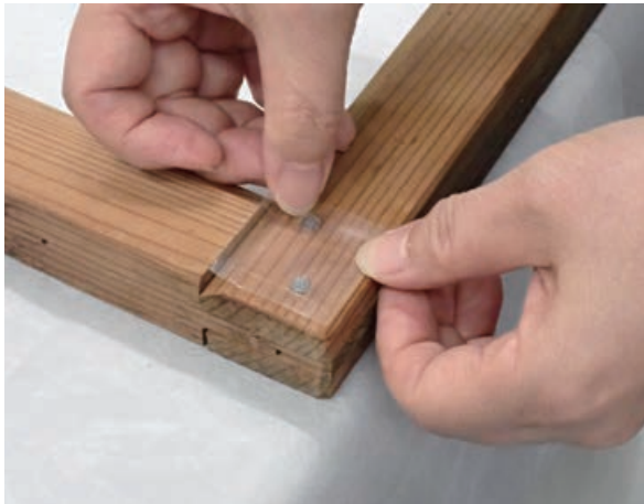
図1-21. 木枠の釘部分の養生
