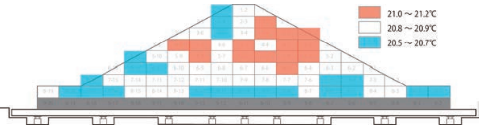
図3 各堤体ブロックの平均表面温度（令和7年10月28日測定）
